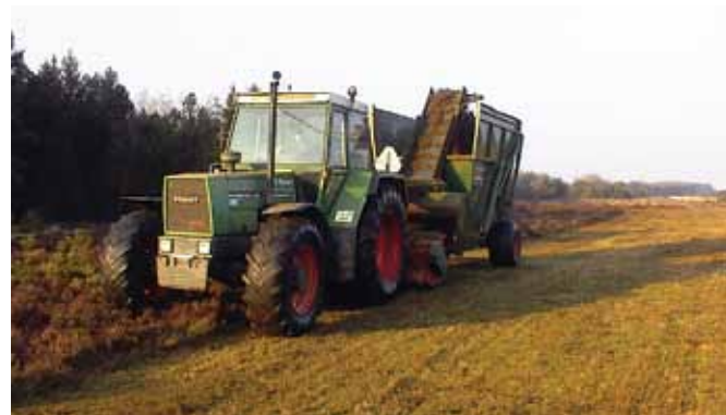
Pleje af heden med Lynghøster monteret med madevalse og transportør med opsamling. Til venstre i fotoet anes arealet før indgreb og til højre – resultatet efter slåning.
