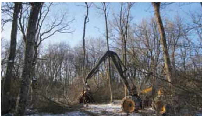
Skovning, udkørsel og knusning skete på frossen jord, hvorved man undgik dybe hjulspor. De største træer blev skovet manuelt.
