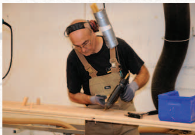
Her bores de døde knaster ud og der bankes propper i, lavet af rundstokke af douglas. Foto: Per Hilbert
