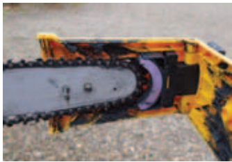
Det åbne slibeaggregat. Slibe-stenen ses med lilla farve.
