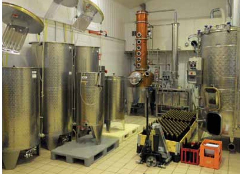
Produktionsfaciliteter med gæringstanke m.m. I baggrunden ses destillationsapparatet, som er indkøbt i Tyskland.
