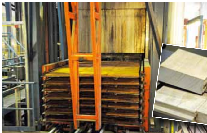
Pressen, hvor staverne pressetørres mellem metalplader i cirka 2 timer ved høj temperatur – et unikt system, som andre gulvfabrikker forgæves har forsøgt at efterligne. Indsat: Samling af staverne efter udfræsning med den såkaldte Lindemann maskine fra 1931. Fotos: Per Hilbert
