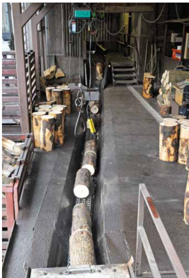
Produktionen starter med, at de 2,75 meter lange 'Juncker-kævler' bliver afbarket og kappet op i triller på 66 centimeter, hvorefter trillerne skæres op i staver. Foto: Per Hilbert
