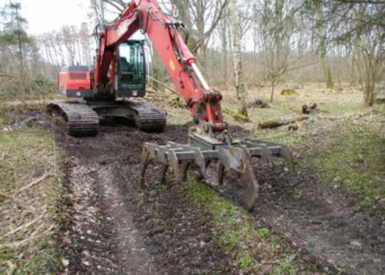
Kvasskubber monteret på bæltegraver. Kan kun bruges til at skubbe hugstaffald, da den mangler overfaldsgreb. Anvendes til at skubbe hugstaffaldet i ranker. Foto: Ulrik Kragh Hansen.
