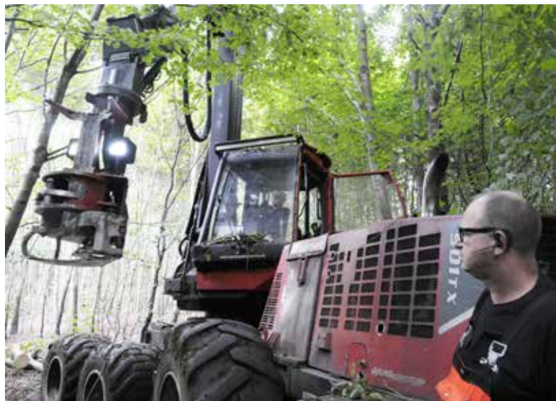
Der lægges ned til flis i en yngre bøgebevoksning. Peder Frederiksen ser til sønnen Jens, som kører med fældebunkelæggeren. Der kunne have været vist ud i forvejen, men sammen med skovfogeden har man skønnet, at det ikke havde betalt sig.
