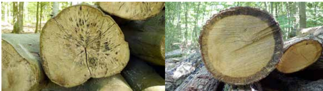
Kævle-ender: En bøgekævle (tv.), som ligger i skoven, bliver hurtigt angrebet af svampe. På egekævlen (th.) bliver splinten hurtigt misfarvet af svamp, mens kernen kan holde sig frisk i flere år.
