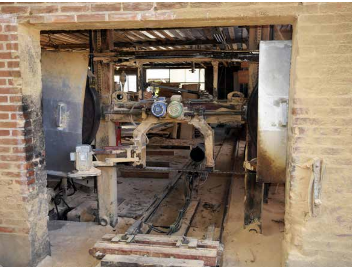
Vandret båndsav på Ryslinge savværk. Skærer kævler på op til 140 cm i diameter.
