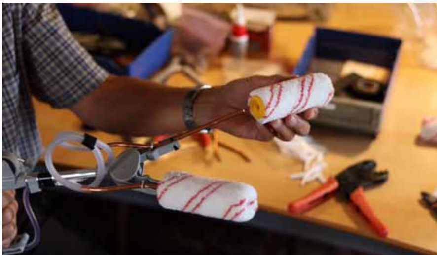
To malerruller påfører kemien på træerne. En lille pumpe presser væsken ud igennem kobberrørene og ud i rullerne.
