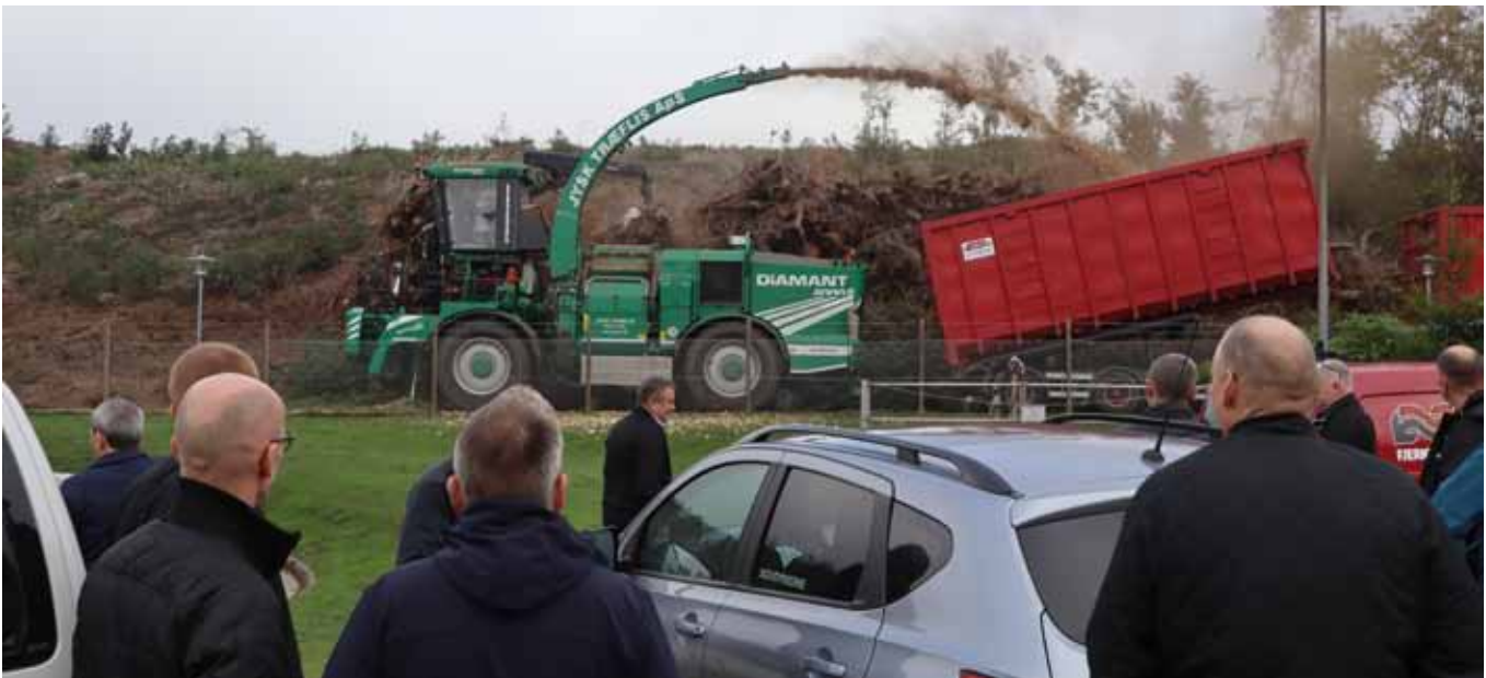
Der blev blandt andet demonstreret hugning af flis med en Albach Diamant 2000-hugger.
