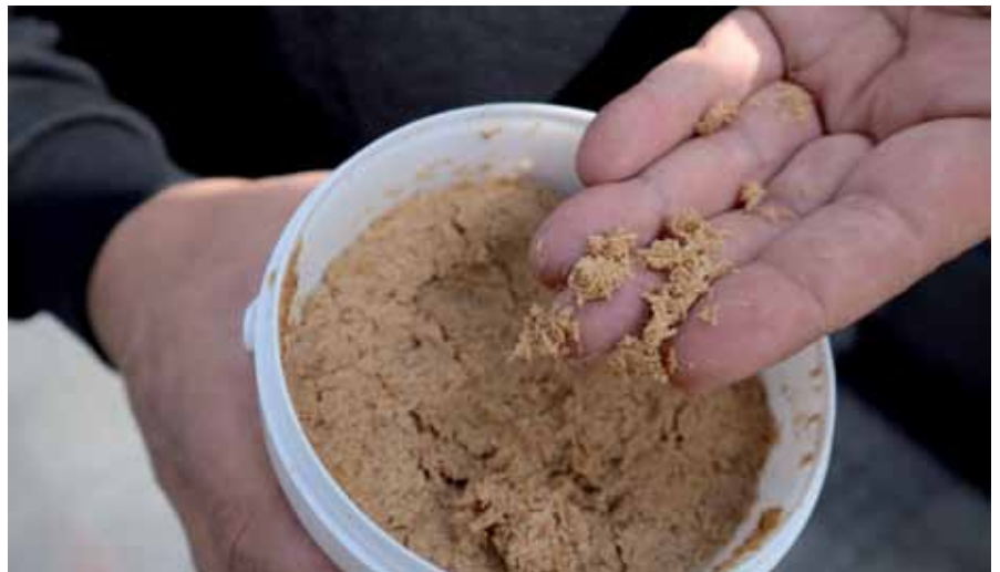
Anlægget kan producere brændstof af alle træarter. Som det første led i processen findeles træet, og det blandes med vand.
