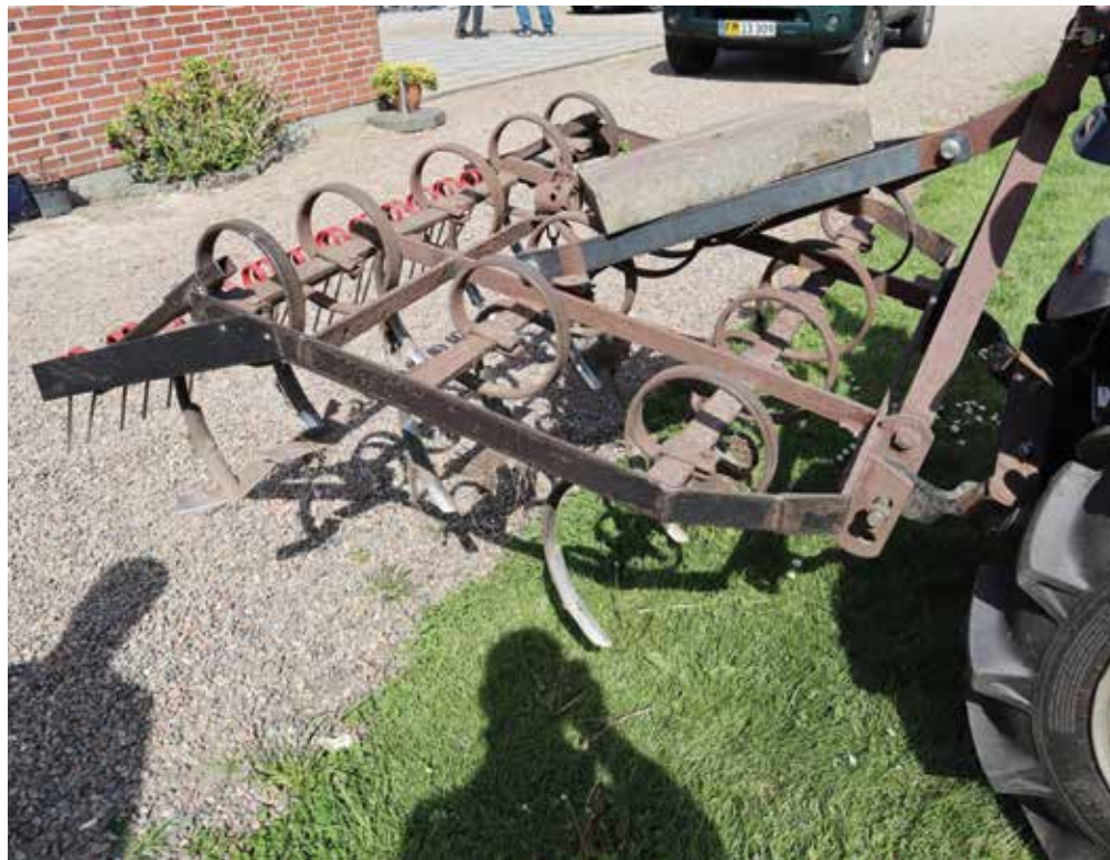
Harven har Hans Ølgaard selv konstrueret, så den passer til rækkeafstanden. Forrest er der monteret et par rækker med løsnende tænder. Bagved er der en række med fuld gennemskæring og til sidst en strigle.
