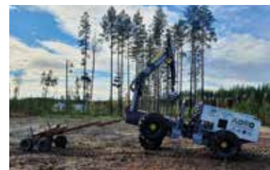
Den nye selvkørende skovmaskine. Foto: Luleå Tekniske Universitet
