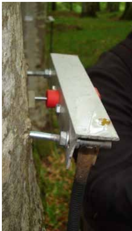
Diametertilvæksten blev målt for hver time med en lille måler. Det skete 365 dage om året.
