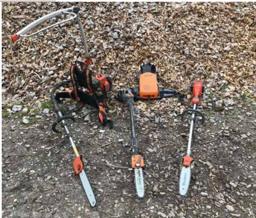
De tre afprøvede udrensningssave. Fra venstre ses benzindrevet rydningsav fra Husqvarna 535 FB, i midten er det en elektrisk teleskopstangsav fra Pellenc og til højre ses elektrisk rydningsav fra Husqvarna 536 LiPX.
