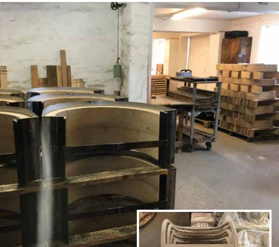
Emnerne bliver i mange tilfælde videreforarbejdet. Dampbøjet som her, faconskåret og slebet og i mange tilfældet samlet til fx næsten færdige møbler.
