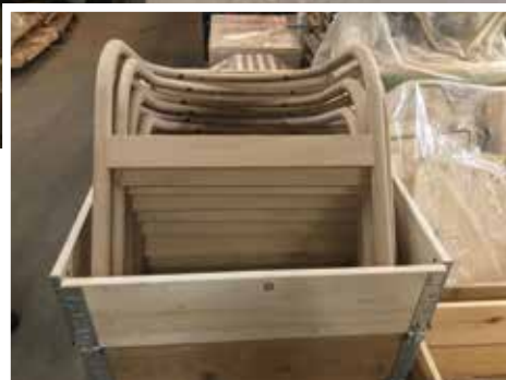
Emnerne bliver i mange tilfælde videreforarbejdet. Dampbøjet som her, faconskåret og slebet og i mange tilfældet samlet til fx næsten færdige møbler.
