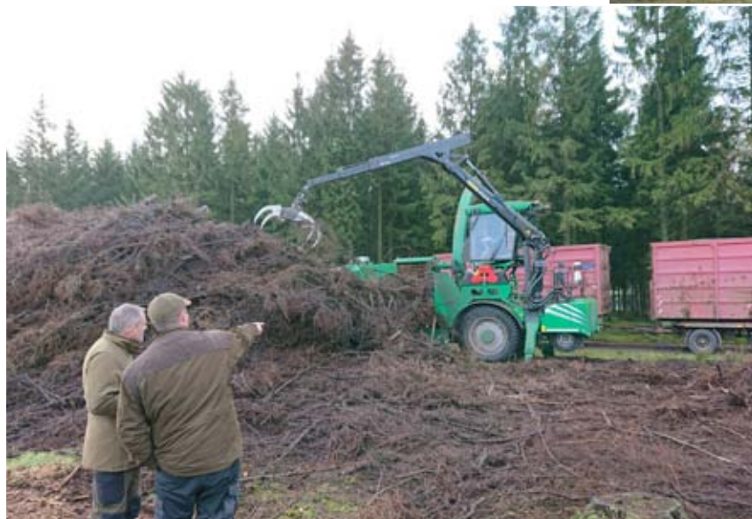
Foto øverst. Traktormonteret TP hugger i færd med at hugge topende i en afdrift af rødgran. Denne type kan hugge flis i tyndinger og på afdrifter. Maks diameter på topenderne er 40 cm, men oftest vil middeldiameteren være omkring 12-14 cm.
