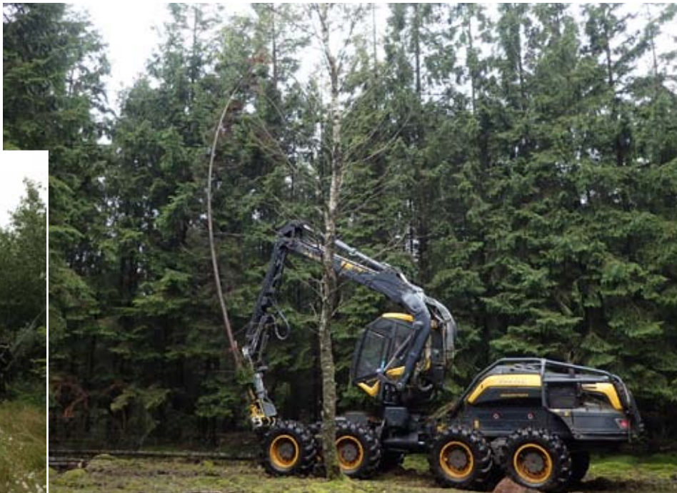
Tynding af mellemaldrende rødgran med fældebunkelægger. Denne maskine har en lang rækkevidde, høj præstation og kan lægge træet optimalt tilrette for terrængående hugning.
