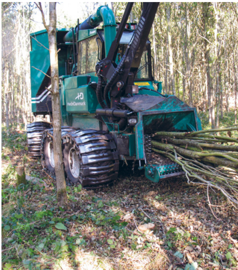
Fig. 24 & 25. I venstre billede (24) ses bunker af småt dimensioneret træ som er blevet fældet og bunkelagt. Ovenfor (25) ser man, hvordan et bundt småtræer føres ind i en flishugger, der sønderdeler træerne til flis, som siden transporteres til varmekværk.
