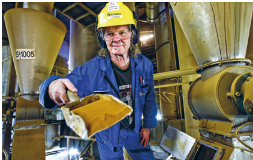
Fig. 22. Lignin var tidligere et spildprodukt ved papirfremstilling som medførte miljøproblemer. Imidlertid har den norske koncern Borregård fundet nye anvendelser for lignin. Det anvendes som indblanding i beton og andre byggematerialer, hvor den mindsker cementandelen og gør betonen stærkere og lettere. Derudover bruges den i tekstilfarver og keramiske produkter. Desuden har den bindende og dispergerende egenskaber og bruges til at holde sammen på diverse pellets i landbruget, hvorved man opnår bedre opløselighed og færre støvgener. Og en dråbe lignin i væsken i et bilbatteri modvirker krystallisering og øger derfor batteriets levetid. Her ses en medarbejder med lignin-pulver.
