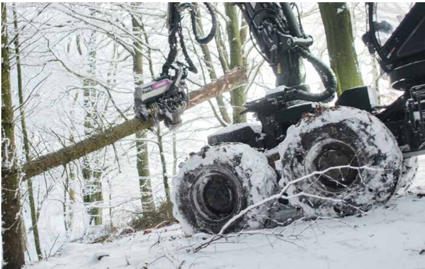
Sitkagranerne fældes under gode vinterforhold med frossen jord, så køreskader minimeres
