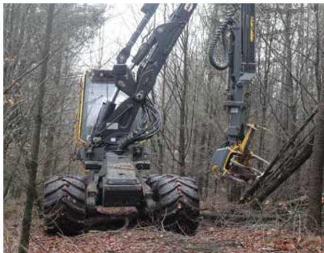
En stor del af arbejdet handler om at pleje og tynde bevoksninger, der er plantet efter 1999-stormen. Her lægges der spor i en af bevoksningerne med fældebunkelægger.
