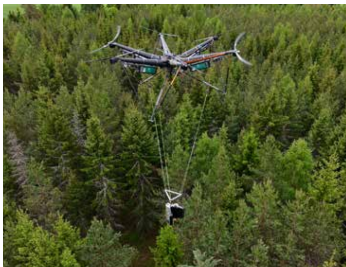
Dronen placerer sig over trækronen og sænker fældeværktøjet ned. Træet afgrenes, fældes og løftes ud af skoven fra luften. Foto: AirForestry
